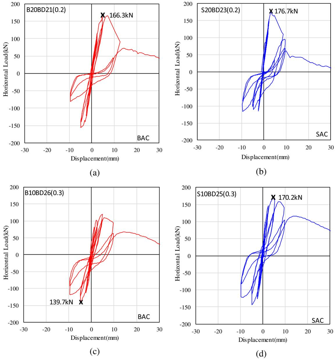
FIGURE 5 Load-deflection curves of four selected specimens. (a) B20BD21(0.2). (b) S20BD23(0.2). (c) B10BD26(0.3). (d) S10BD25(0.3).
